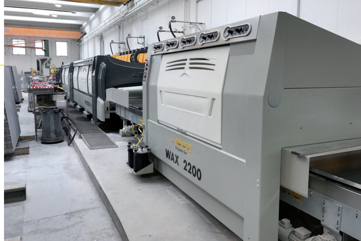
Particolare della ceratrice modello WAX 2200. / Detail of the waxing machine model WAX 2200.
